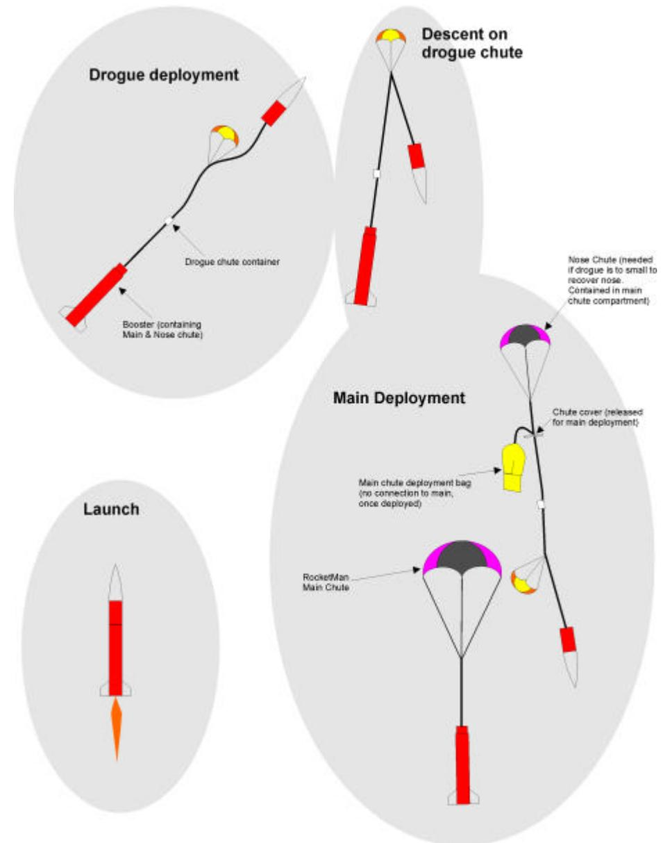
Wichtig bei einem zuverlässigen Bergungssystem ist sicherlich auch Redundanz! Die beste Elektronik kann versagen, auch Ausstossladungen zünden nicht immer. In solchen Fällen ist es wichtig, dass vor allem für den sicherheitskritischen Drogue Chute Reservesysteme vorgesehen werden. Dies kann zum Beispiel ein Timer sein, welcher auf 23 sek nach dem berechneten Gipfelpunkt eingestellt wird und eine eigene Ausstossladung besitzt.
