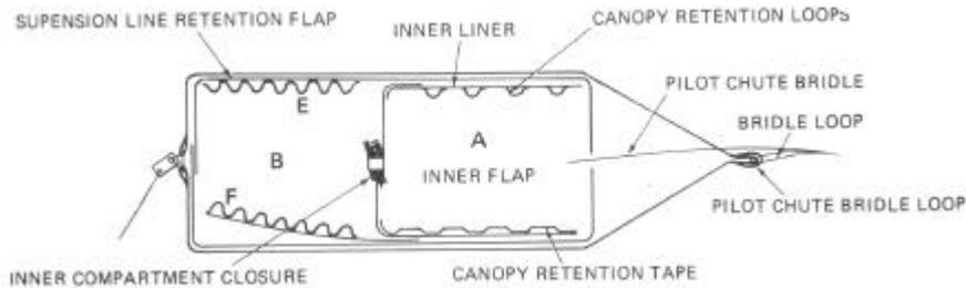
Ein Deployment Bag erlaubt einerseits eine sehr dichte Packung des Fallschirmes und sorgt andererseits für eine definierte Sequenz der Fallschirmmentfaltung wie bereits erwähnt.
