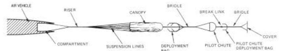
In einer ersten Phase wird ein Pilot chute ausgebracht, welcher für eine erste Abbremsung sorgt bevor er den Deployment Bag des Hauptfallschirmes herauszieht. Hierbei werden zuerst die Leinen des Hauptfallschirmes gestreckt, bevor der Hauptschirm freigegeben wird.
